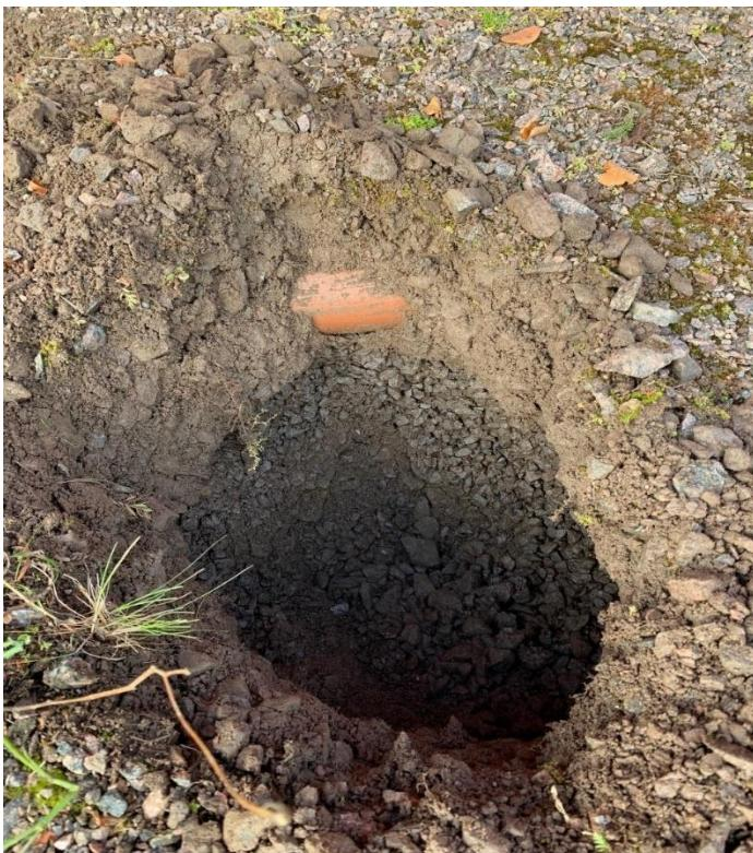
**Foto 5.3.** Visar exempel på jordlagerföljd i provpunkt SM11E. I bilden syns även ett ledningsrör för dagvatten. Röret orsakades ej någon skada vid markundersökningen.
